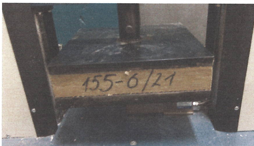
Рисунок 5 – Проведення випробування та типова експериментальна залежність міцності на стиск при 10% деформації зразків теплоізоляційного матеріалу марки «ТЕХНОРУФ В ПРОФ»
